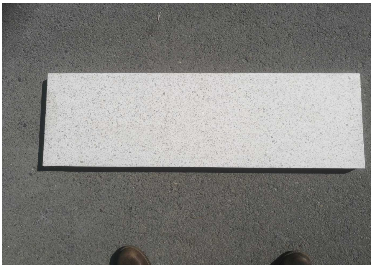
Foto opravené praskliny – bílé teraso – na druhý den, foto z výšky cca 1,0 – 1,2m
